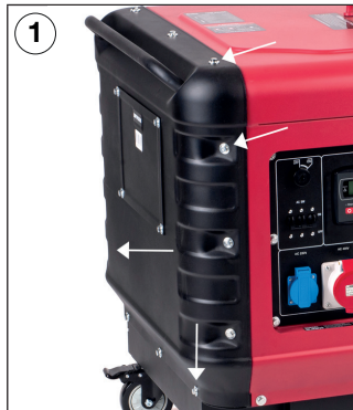
Fjern ytre deksel ved å fjern 12 skruer; 4 på topp, 4 i bunn og 4 på hver side.
